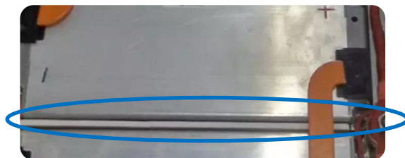
Module to Module Insulation Nomex® CI10
